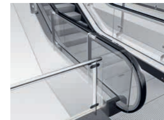
Barrière de protection anti-chute de passagers, jusqu'à une hauteur de 1300 mm. Elle est recommandée si une chute de plus de 6 m est possible
