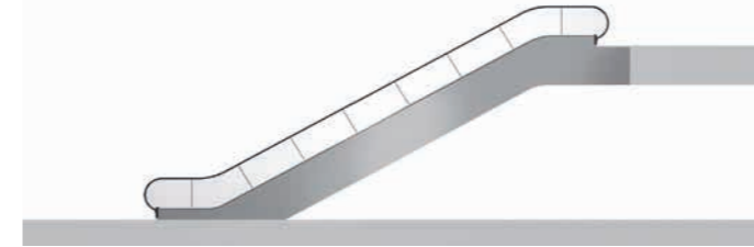
En standard, les joints entre les volumes verriers de la balustrade sont disposés perpendiculairement à la charpente. Les panneaux inclinés ont une largeur de 200 mm, à l'exception du panneau supérieur dont la largeur est variable afin de compenser l'élévation.
